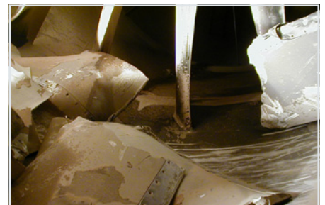
Der Bruch von Schaufeln als Konsequenz von Strömungsabbrissen.
