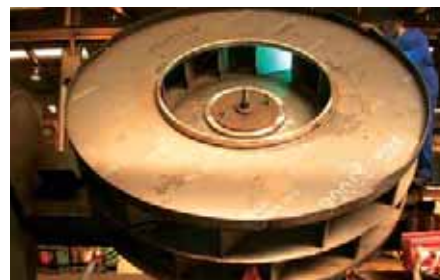
Roue d'entrée destinée à la rénovation d'un ventilateur ID de groupe de préchauffage d'une cimenterie
